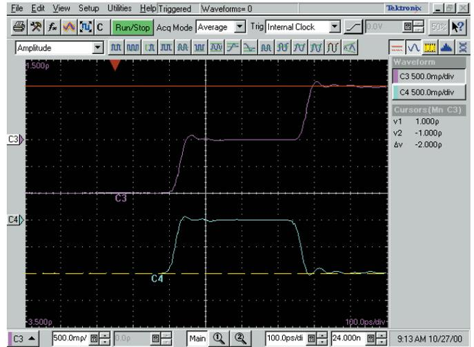
그림 21. DSA8200 디지털 샘플링 오실로스코프와 80E04 20GHz 샘플링 모듈의 TDR(Time Domain Reflectometry) 디스플레이
