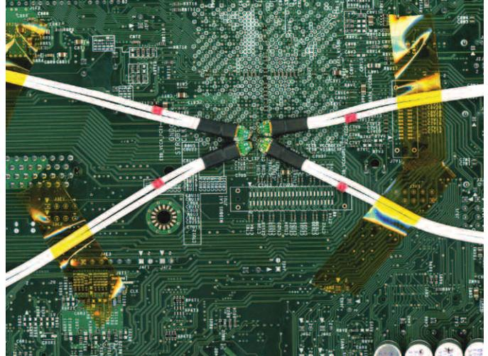
그림 40. 촘촘하게 밀집된 장치 및 시스템의 경우 작은 규격의 프로브가 필요합니다.
